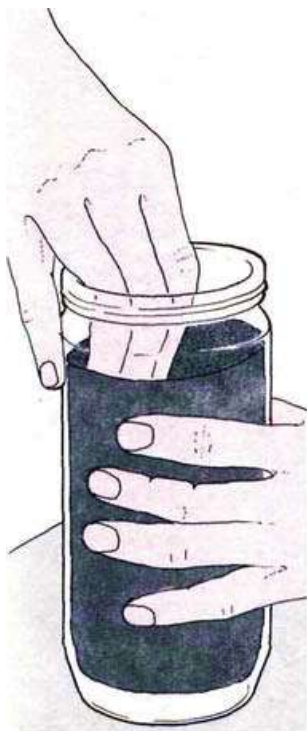
1 Банку с навинчивающейся крышкой выстилают изнутри куском наждачной бумаги.
